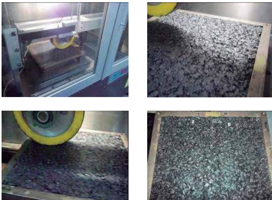
Fig. 5. Procedimiento de carga con el WTT en las probetas - 3 pasadas una al lado de la otra
