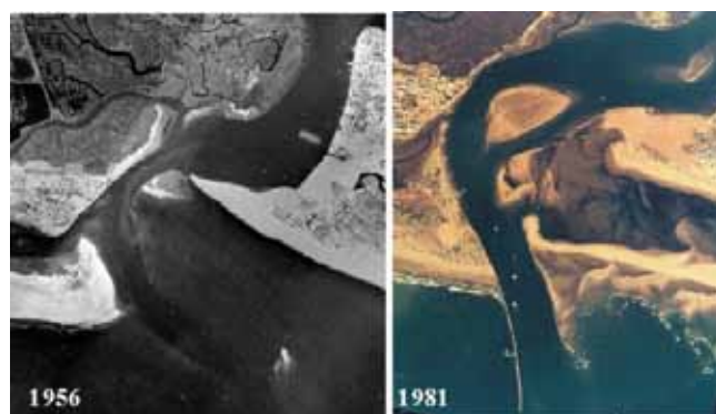
Fig. 2. Transformación de la costa por construcción de encauzamientos (Río Carreras)
