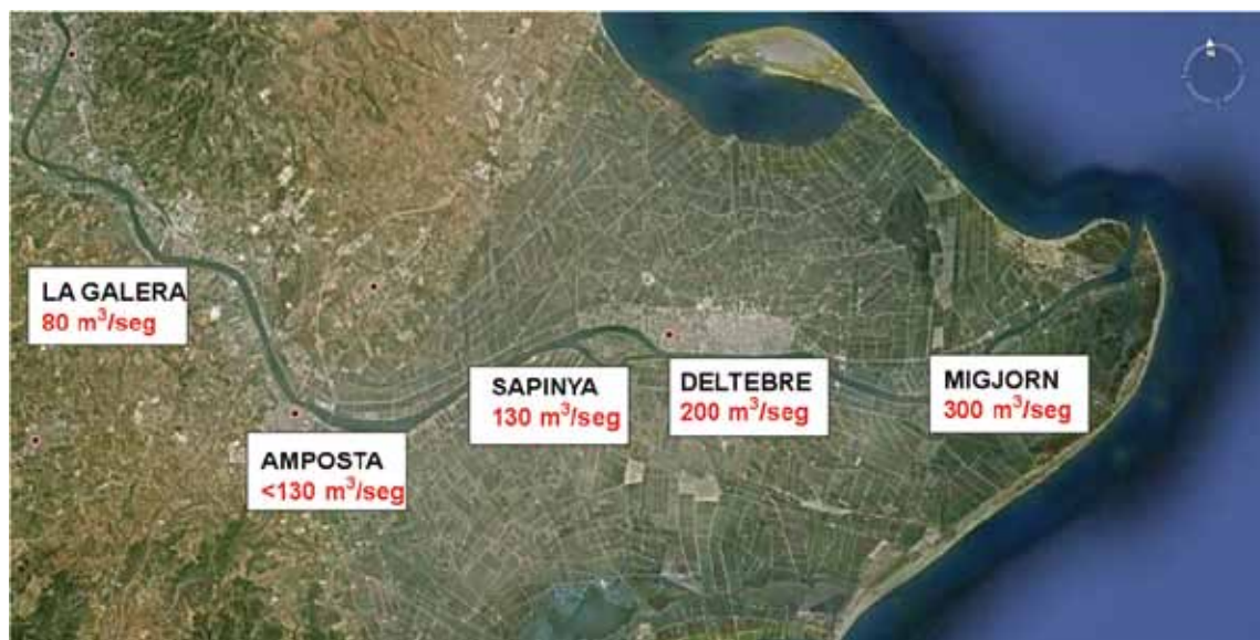
Fig. 2. Penetraciones de la cuña salina con relación a los caudales del río
