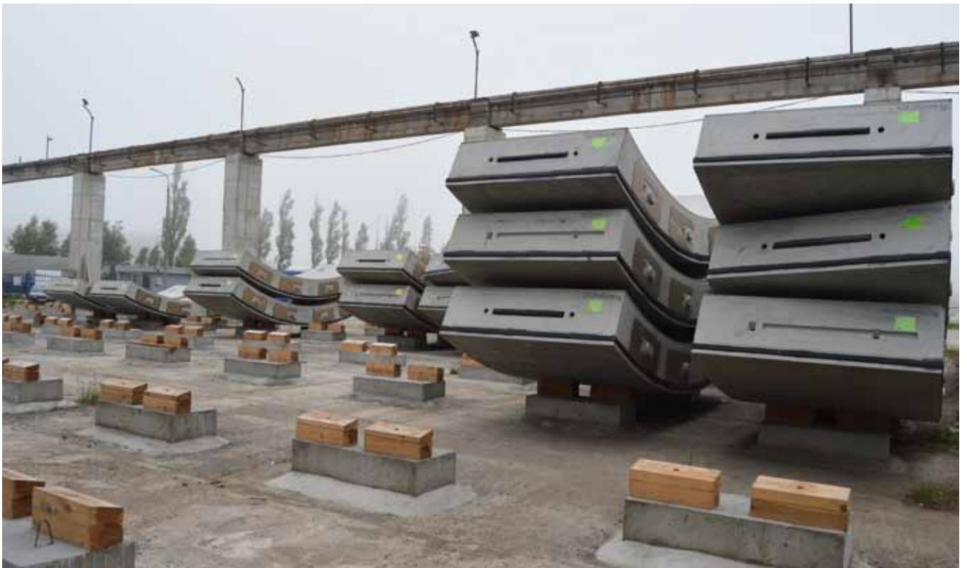
Túnel carretero de Gdansk, de OHL. Se necesita fabricar un mínimo de 28 dovelas al día para que la tuneladora pueda avanzar los 10 m/día habituales
