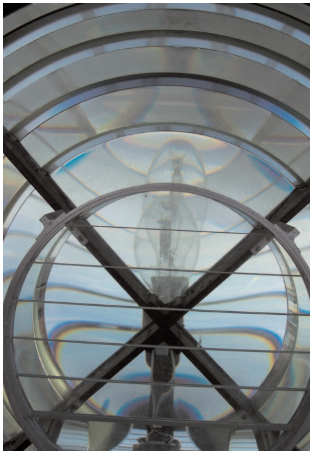
Fig. 12. Óptica y linterna del faro nuevo de Silleiro.
