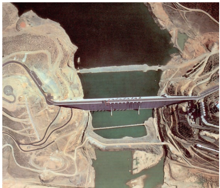
Planta de ataguías y desvío del río.
