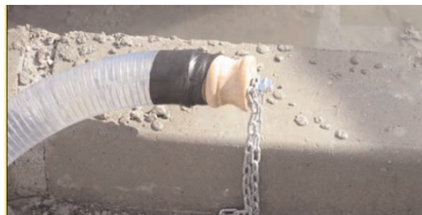
Foto 2. Tapón de cierre del tubo utilizado en una de las pruebas/ Photo 2. Blanking plug used in one of the tests.
