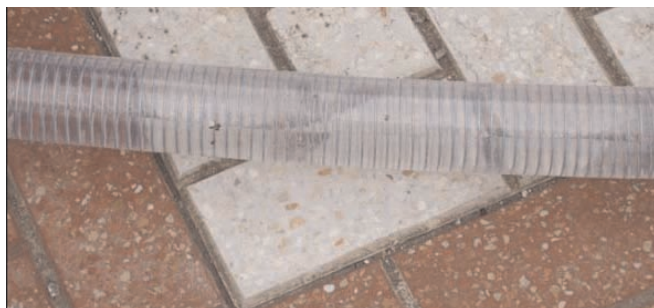
Foto 1. Detalle del tubo utilizado. Se aprecia el refuerzo helicoidal interior de acero/ Photo 1. Detail of the pipe employed showing the internal steel helical reinforcement.
