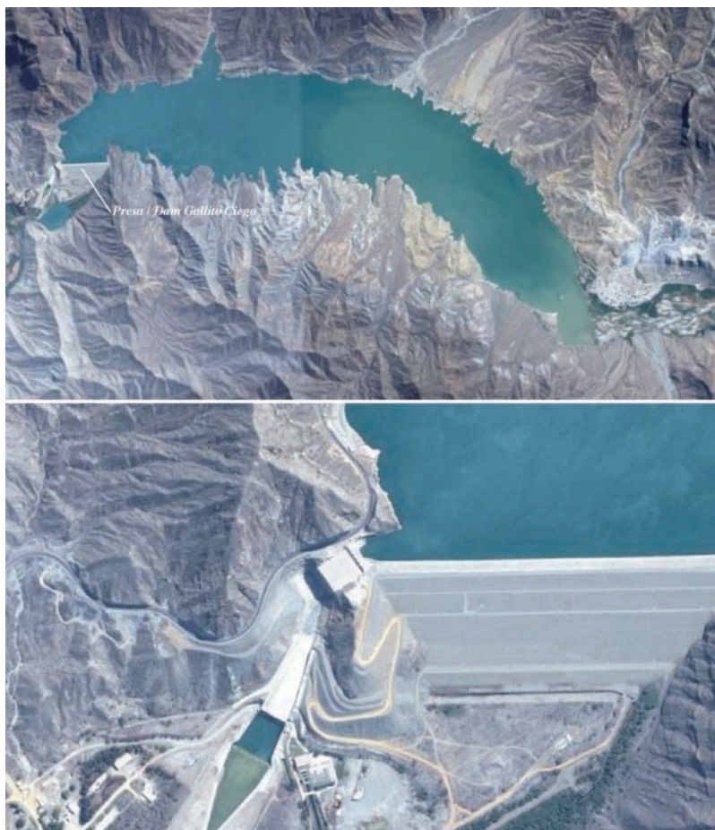
Fig. 6.1. Presa de tierra / Earth Dam Gallito Ciego, concluida en / completed in 1987, la cual con su altura de / which with a height of 114 m, fue la presa más alta de Sudamérica en los años 80 / was the highest dam in South America during the 80's. (Fotos fuente / Photos source: Google Earth 2007).
