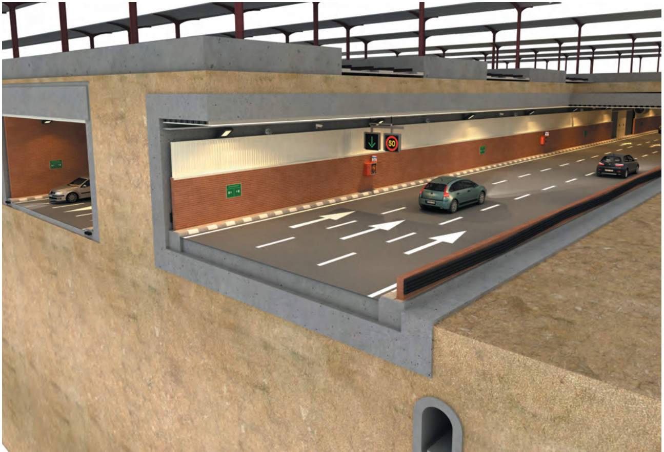
Fig. 9. Vista del nuevo túnel bajo vías FFCC / General view of the new tunnel under the Station.
