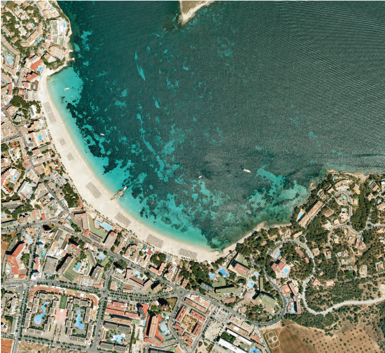
Fig. 11. Contraste de los anchos de playa emergida y sumergida entre los años 1955 y 2005. Playa de Magaluf, T.M. de Calviá (Mallorca). Véase como las zonas vegetadas son incluso más extensas y tupidas actualmente que antes de la "alimentación masiva" con arenas procedentes de los fondos marinos relictos da la zona de Refeubeig. FOTOS CEDIDAS POR ESTOP FOTOS AÉREAS.
