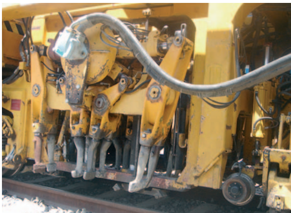
Fig.12. Longitud de bates de la bateadora (foto MMM).
