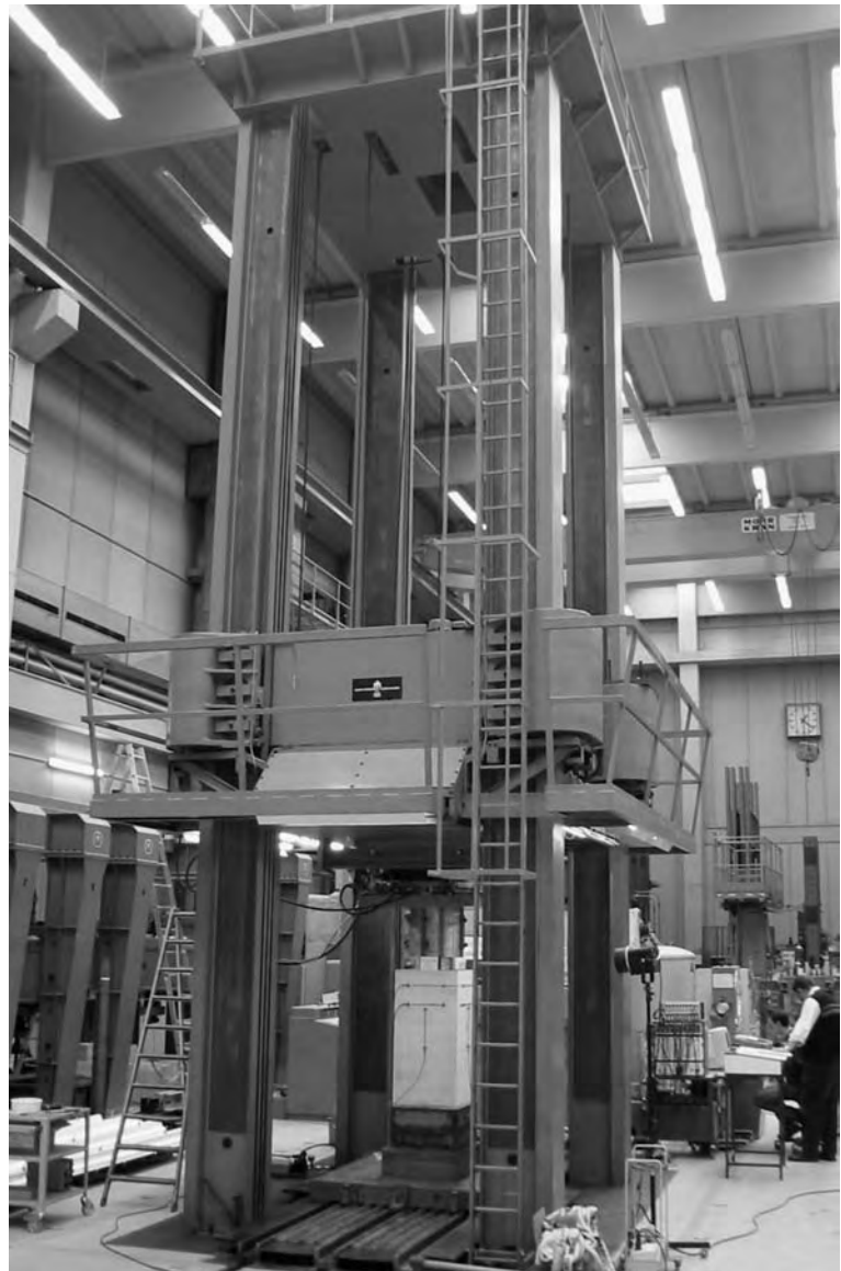
Fig. 6. Ensayo de transferencia de cargas. Muestra e instrumentación instaladas/ Load transfer test. Mounted specimen and instrumentation.
