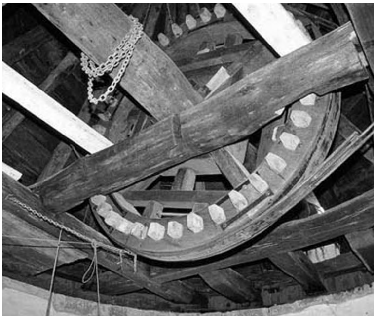
Rueda catalina y eje principal. Abajo, Vista general y sección.
