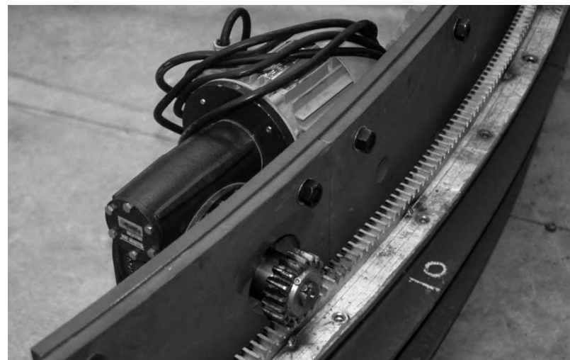
Sistema de giro de la parte móvil.
