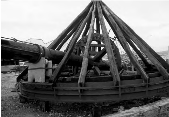
Parte giratoria con el eje y la rueda catalina. A la derecha, detalle del apoyo del eje en la piedra bollega.
