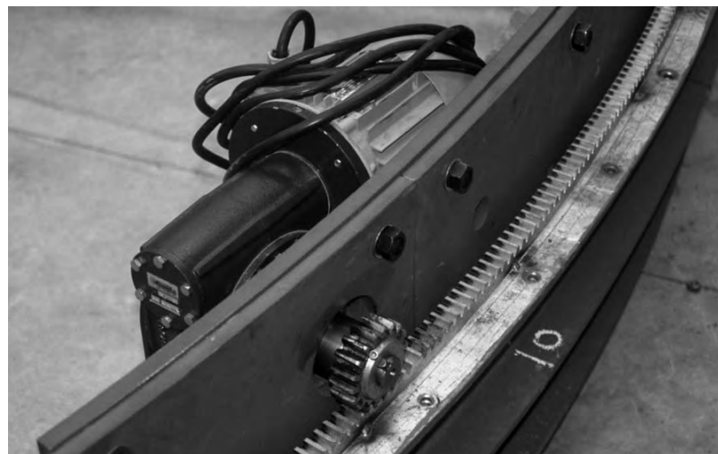
Sistema de giro de la parte móvil.
