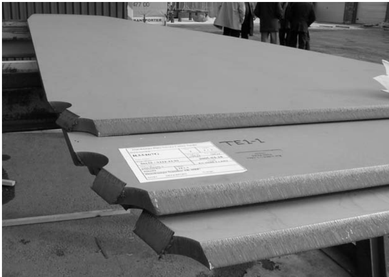
Fig. 14. Corte y preparación de bordes en Suecia/ Cutting and edge preparation on Sweden.
