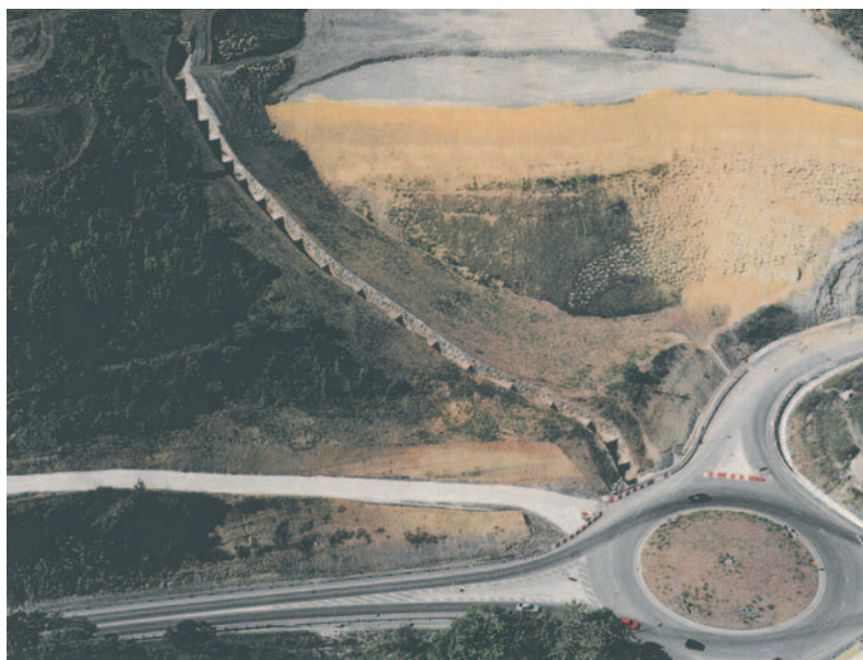
Fig. 12. Bajante escalonado tipo.
