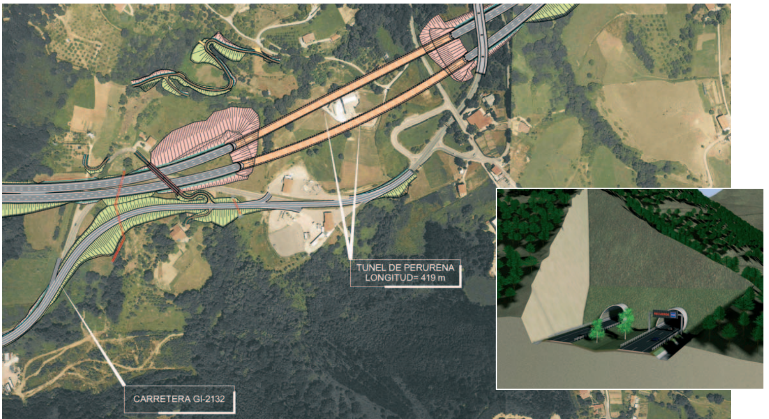
Fig. 8. Túnel de Perurena. Boquillas.
