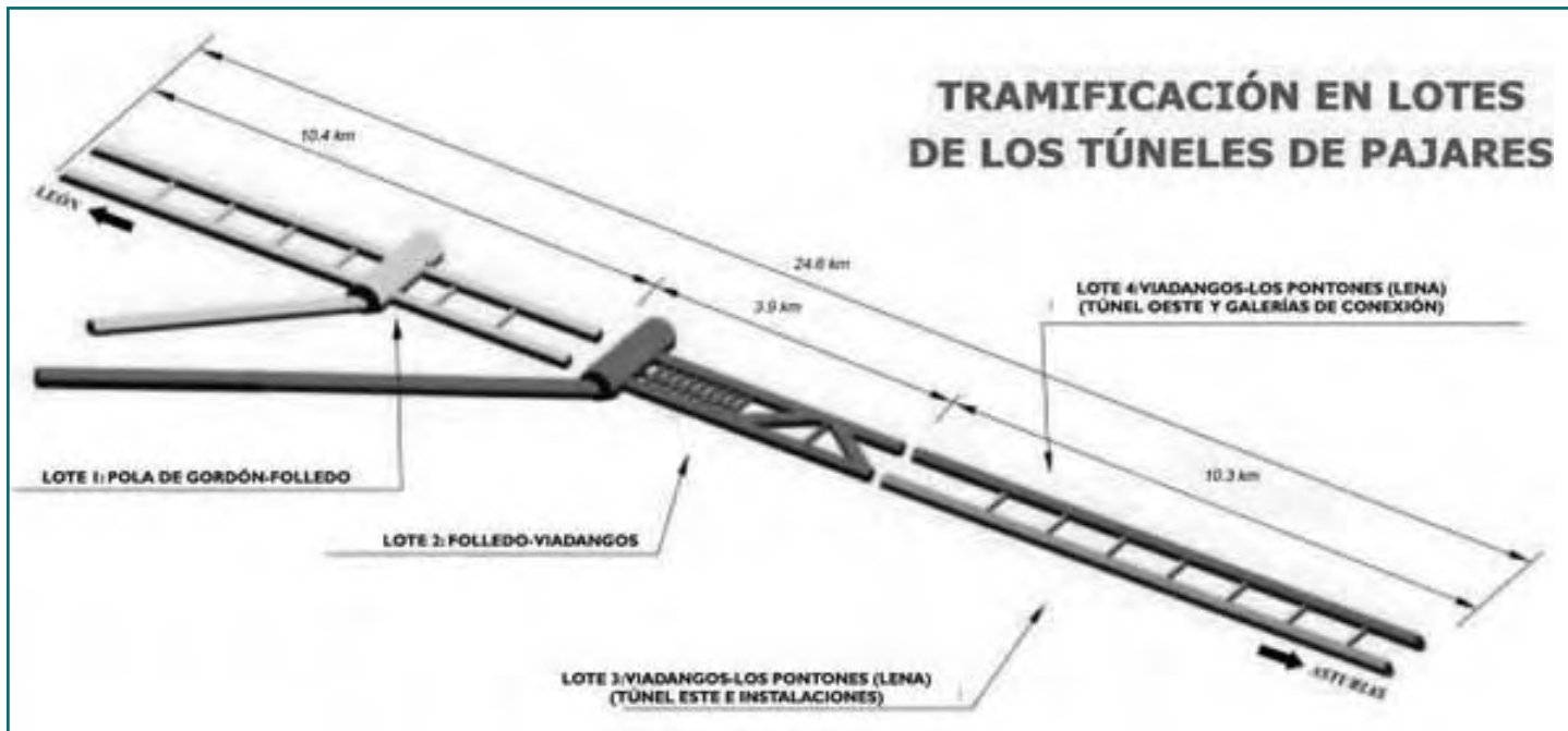
Fig. 2. División en lotes de los Túneles de Pajares/Contract sub-division of the Pajares tunnels.
