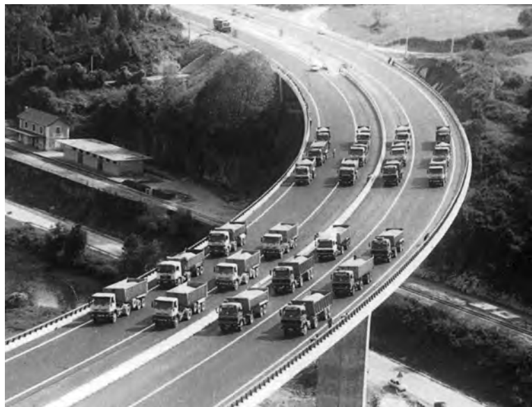
Fase prueba de carga (2). Cortesía Geodisa.
