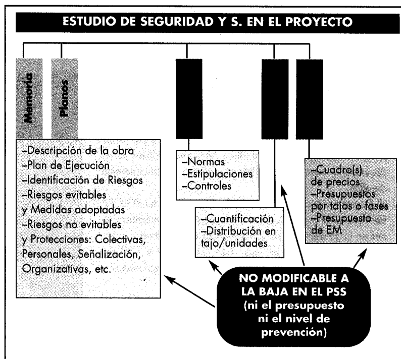
Contenido del ESS (extracto del RD 1627/97).
