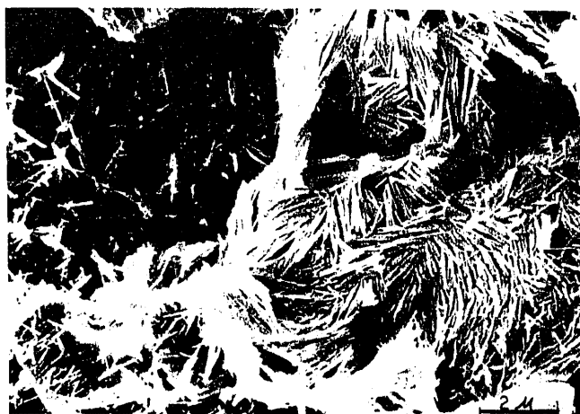
Figura 3.—M.E.B. Cristales de brucita en la zona de contacto entre el árido y la pasta.
