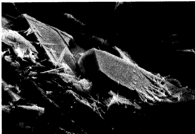
Figura 8.- MEB. Portlandita X 1200. Muestra CC2. Conservación inicial: Agua.
