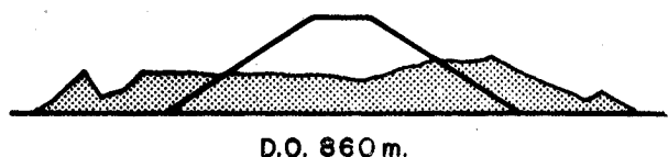
Fig. 3. — Rotura del terraplén del ferrocarril de Hokuriku, en el terremoto de Fukui de 28 de junio de 1968.
