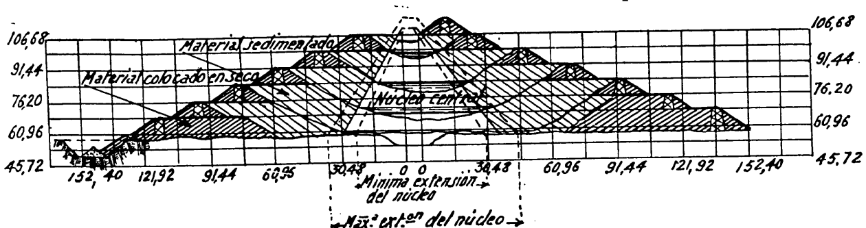
Fig. 2.ª Sección de la presa de Saluda, indicando los sucesivos depósitos de materiales
